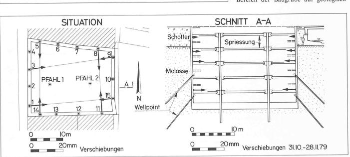
stärker vorbelasteten Baugrund zurückzuführen als im westlichen Bereich der Baugrube. Die an Baugruben gemessenen Verformungen zeigen wie in diesem Beispiel deshalb oft ein unregelmässiges Bild.
