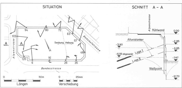
se Verschiebungen können auch bei sorgfältigster Ausführung nicht ganz vermieden werden. Die horizontalen Verschiebungen können sowohl gegen die Baugrube als auch von der Baugrube weg gerichtet sein. Die vertikalen Verschiebungen treten sowohl als Setzungen wie auch als Hebungen in Erscheinung.
