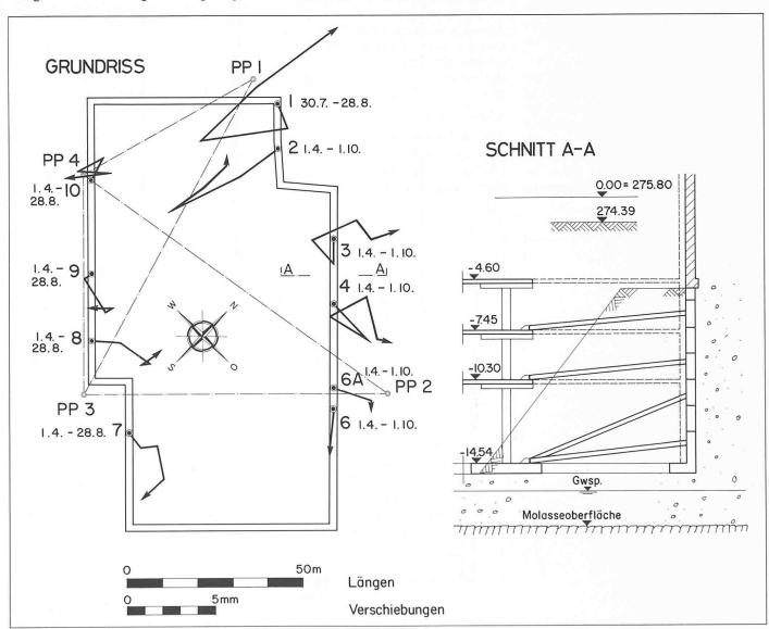
Messungen der Horizontalbewegungen der Baugrubenumschliessung ausgeführt, nachdem die dritte Spriesslage eingebaut war, und die Wellpoint-Anlage zu arbeiten begonnen hatte.
