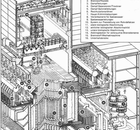
Bild 1. Schema des graphitmoderierten Leichtwasserreaktors, Typ RBMK (Bild IAEO/SVA)
