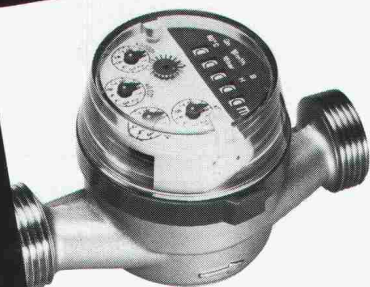
Warmwasserzähler UNICO Keine Verkalkung: Zählwerk durch Messingplatte abgetrennt. Für waagrechten und senkrechten Ein- bau. Anschluss 1/2" oder 3/4".
