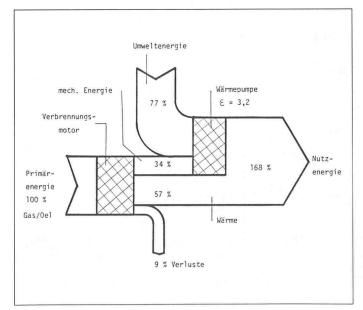
Bild 2. Nachträglich angebaute Heizzentrale mit Gasmotorwärmepumpe, Umweltenergiequelle Aussenluft
