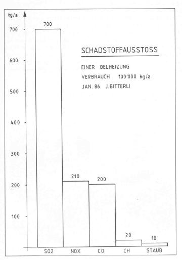
Bild 5 (links). Schadstoffausstoss bei Ölheizung
