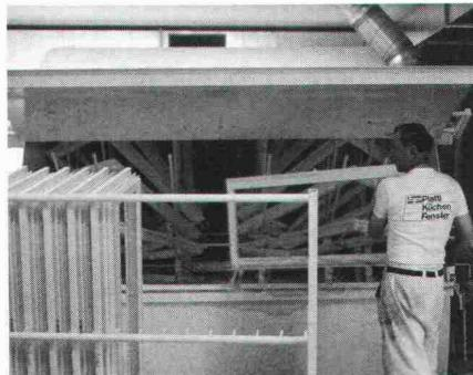
Auf eine fachgerechte Oberflächenbehandlung wird bei Piatti-Fenstern ganz besonderer Wert gelegt. Im Unterschied zu herkömmlichen Techniken werden Rahmen und Flügel bei Piatti vollständig und ohne Beschläge langzeitgetaucht. So kann die Grundierung tiefer und intensiver in das Holz eindringen. Der Schutz vor Verwitterung, Verschmutzung und Feuchtigkeit ist damit optimal garantiert. Das Piatti-Holzfenster Typ H ist nur
