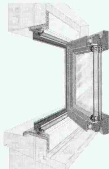
Weise die drei Materialien Holz, Aluminium und am Innenrahmen Kunststoff. Es ist auch sofort gebrauchsfähig, ohne dass irgendwelche Abschlussarbeiten vom Maurer, Gipser, Tapezierer oder Maler notwendig werden. Und schliesslich ist es in kürzester Zeit montiert: für eine Wohnung rechnet man durchschnittlich einen halben Tag. Deshalb gibt es für Renovationen nur eine Lösung: Piatti.
