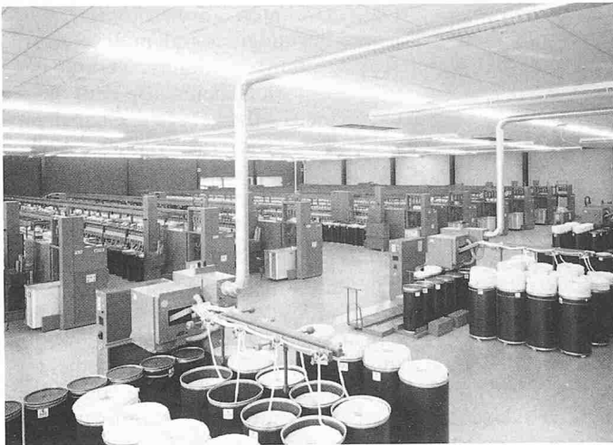
Bild 4. Moderne Spinnereianlage (Spinnerei an der Lorze, Baar) mit Rieter-Rotorspinnmaschinen M 2/1 und Rieter-Strecken D1/1 und D1/2. Der harmonisierte Gesamtwirkungsgrad liegt mit 93% sehr hoch
