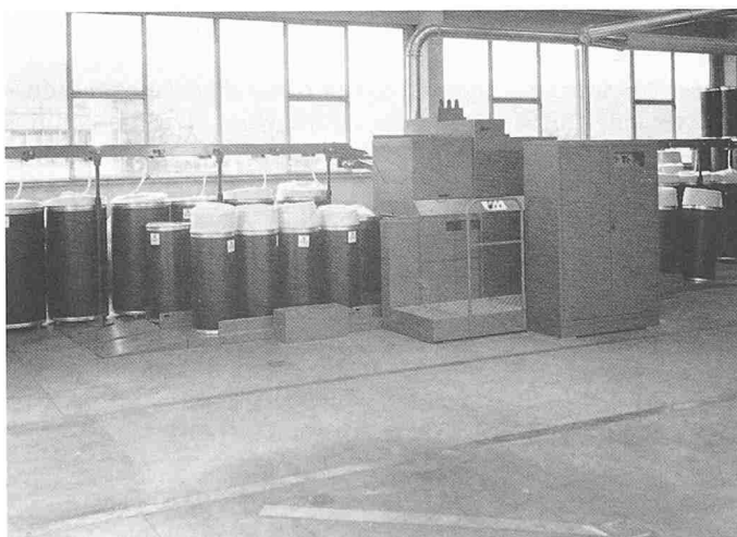
Bild 2. Rieter-Hochleistungsstrecke D 1/2 (Baujahr 1985) mit automatischem Wechsler für Spinnkannen. Spitzengeschwindigkeiten bis 800 m/min mit regulierter Faserbandqualität. Steuerschrank für Elektronik und Elektromechanik servicefreundlich vorne angeordnet
