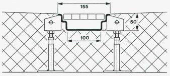
Das ist die neue BRODER-Parkingrinne für den Direkteinbau mit der klaren technischen Überlegenheit der Höhen- und Gefällsnivellierung. Die kleine Einbauhöhe von 50 - 300 mm bringt einen wesentlichen Gewinn an statischer Höhe. Der Direkteinbau mit dem enormen Montagekomfort bringt einen Verzicht des teuren Aussparens und somit eine deutliche Senkung der Einbaukosten.
