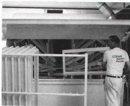
Auf eine fachgerechte Oberflächenbehandlung wird bei Piatti-Fenstern ganz besonderer Wert gelegt. Im Unterschied zu herkömmlichen Techniken werden Rahmen und Flügel bei Piatti vollständig und ohne Beschläge langzeitgetaucht. So kann die Grundierung tiefer und intensiver in das Holz eindringen. Der Schutz vor Verwitterung, Verschmutzung und Feuchtigkeit ist damit optimal garantiert. Das Piatti-Holzfenster Typ H ist nur
