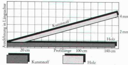
Für Piatti-Fenster ist nur das beste Material gut genug: Holz. Qualitätstests beweisen, dass Holz nach wie vor das ideale Material im Fensterbau ist. Denn einerseits sorgt Holz als Naturprodukt für eine optimale Wärmedämmung und trägt somit wesentlich zur Energieeinsparung bei. Und andererseits weist Holz
