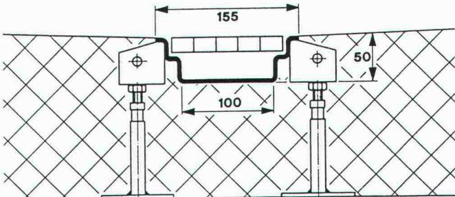
Das ist die neue BRODER-Parkingrinne für den Direkteinbau mit der klaren technischen Überlegenheit der Höhen- und Gefällsnivellierung. Die kleine Einbauhöhe von 50 - 300 mm bringt einen wesentlichen Gewinn an statischer Höhe. Der Direkteinbau mit dem enormen Montagekomfort bringt einen Verzicht des teuren Aussparens und somit eine deutliche Senkung der Einbaukosten.
