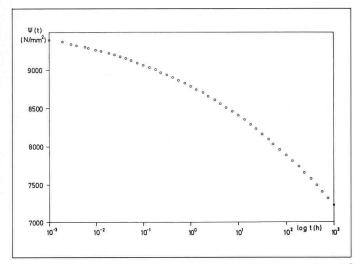
Bild 9a. Relaxationsverlauf des glasfaserverstärkten Polyesters zwischen 10<sup>-3</sup> Stunden und 1000 Stunden
