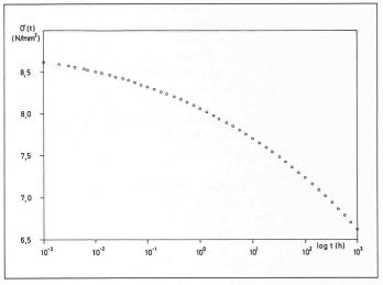
Bild 9b. Spannungsverlauf im glasfaserverstärkten Polyester für den Lastfall, gleichmässige Erwärmung um  $\Delta T = +25^{\circ} C$  zwischen  $10^{-3}$  Stunden und 1000 Stunden
