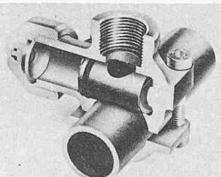
ausgeschnittene Rohrteil bleibt im Gehäuse des T-Stückes. Der Schnittkolben gibt durch seine Bohrung gleichzeitig den Durchgang des Mediums in die neue Abzweigung frei und verharrt sicher in der Endstellung. Der Anschlussvorgang durch die eingebaute Treibladung wird nach Fertigstellung der Anschlussinstallation durch einen Hammerschlag auf den Zündstift ausgelöst.
