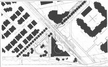
Für die Erschliessung des Krankenheimes bestehen verschiedene Auflagen. Der Fahrverkehr erfolgt über die Friesenbergstrasse. Vor allem darf aber das Trassee der SZU weder für den Fahr- noch den Fussgängerverkehr à niveau überquert werden. Der Standort der künftigen Bahnstation SZU liegt unmittelbar beim Krankenheim.
