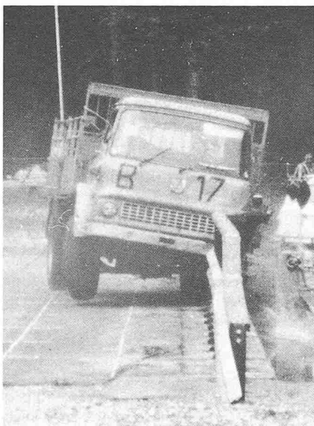
Bild 2. Die Gruppe Strassenbau ist seit Jahren auf dem Gebiet der passiven Sicherheit tätig. Anfahrversuch an Leitschränken auf dem Versuchsgelände des Instituts
