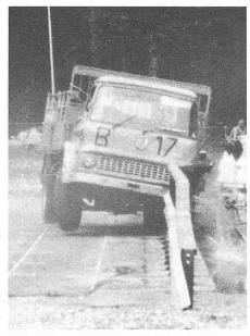
Bild 2. Die Gruppe Strassenbau ist seit Jahren auf dem Gebiet der passiven Sicherheit tätig. Anfahrversuch an Leitschranken auf dem Versuchsgelände des Instituts
