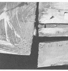
Bild 3. Versuchsbalken B mit Balkenkopf aus Epoxidharzmörtel (links) nach der Zerstörung des Anschlusses: Der Balkenkopf hat sich gegen den Balken verdreht und verschoben. Längs den Schwindrissen wurde das Holz aufgerissen, und die Armierungsstäbe sind stark verformt bzw. zerstört.
