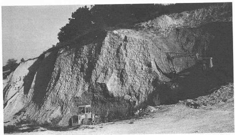
Abbau von Alternativmaterial im Schaffhauser Südranden bei Osterfingen. Der gewonnene Malmkalk-Gehängeschutt (Grien) eignet sich wegen seines bindigen Feinanteils für den Bau von Waldstrassen
