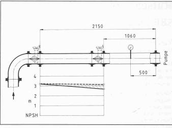
Bild 8. Messanordnung mit Drosselklappe; Verlauf der NPSH-Werte bei 120 l/s Förderstrom für die Abstände 1060 und 2150 mm
