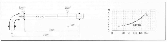
Bild 5. Anordnung der Saugleitung mit Drosselklappe im Abstand 2150 mm und Kurve B Abhängigkeit des NPSH-Wertes vom Förderstrom (s. Bild 3)
