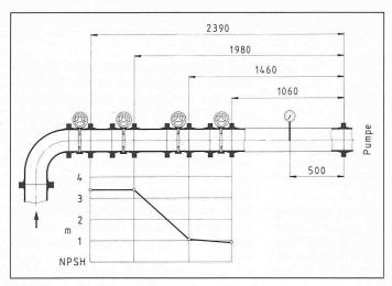
Bild 7. Messanordnung mit Blendenschieber; Verlauf der NPSH-Werte bei 1201/s Förderstrom in Abhängigkeit vom Schieberabstand
