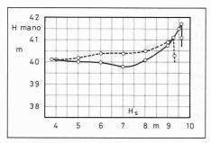
Bild 9. Messwerte für die Anordnung mit Blendenschieber im Abstand 1060 mm;——Messung an der Rohrwand, ---- Messung in Rohrmitte
