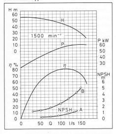
Drosselorgan nicht in gleicher Entfernung vom Pumpenansaugstutzen entfernt. Deshalb wurde auch der Einfluss dieses Abstands untersucht. In Bild 7 ist der Blendenschieber wechselweise in einer Entfernung von 1060, 1460, 1980 und 2390 mm eingebaut. Die Messung wurde in dieser Versuchsreihe nur noch bei einem Förderstrom von 120 l/s, entsprechend dem Bestpunkt des Pumpenwirkungsgrades, durchgeführt.
