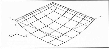
Bild 9. FE-Netz, deformierte Struktur eines Plattenviertels
