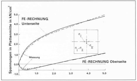
Spannungen in der Mitte einer quadratischen Platte (Oberseite = Seite, an der die Last angreift)
