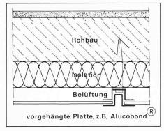
Bild 1. Schematischer Aufbau einer Vorhangfassade
