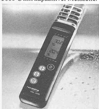
Der MIK 3000-E wird für genaue Feuchtemessungen eingesetzt. Nur mit einer elektrolytischen Feuchtemesszelle können hysteresefreie Feuchtemessungen mit einer Genauigkeit von besser als 1% rF durchgeführt werden.
