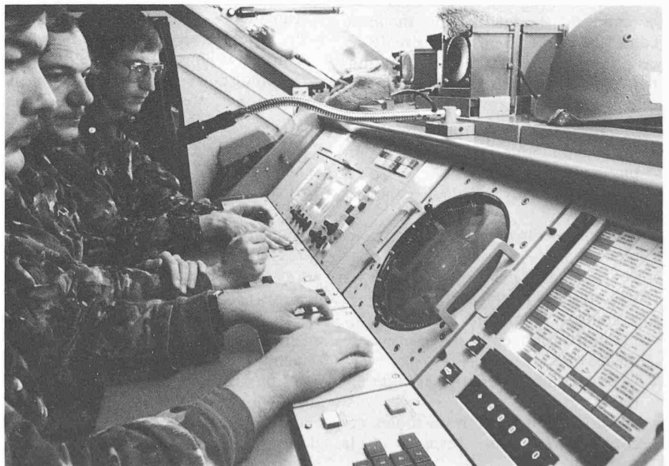
Poste central de l'appareil de conduite du tir DCA «Skyguard»
