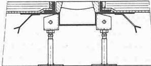
statischen Höhe/Montagekomfort, Einbau in einem Arbeitsgang, keine Aussparung dank verstellbaren Einbaustützen/Senkung der Montagekosten.
