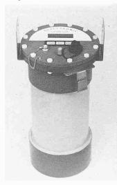
Weitere Vorteile, wie z. B. einstellbarer Alarmpunkt, Zeitsynchronisierung verschiedener Messstellen, wasserdichtes Ge-häuse usw., machen den «Survey Logger» zum kompletten Messsystem, wenn es darum geht, Kanalnetze auszumessen und zu überwachen.
