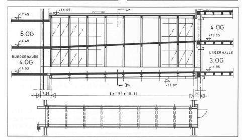
Bild 2. Längsschnitt und Grundriss der Passerelle
