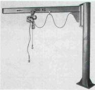
Säulen-Schwenkkrane Schwenkbereich 270° oder 360° 125–2000 kg. Hand- oder Elektro-Kettenzug nach Wahl.
