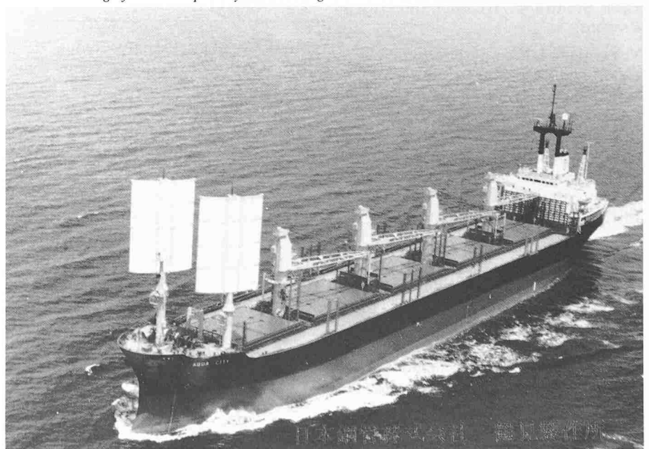
Bild 4. Massengutfrachter «Aqua City» mit Stahlsegeln. Dieselmotor Sulzer-6RTA-58
