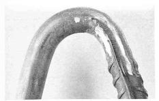
Bild 9. Biegeprobe, geschweisst mit 23/12-Elektrode
