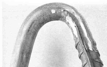
Bild 9. Biegeprobe, geschweisst mit 23/12-Elektrode
