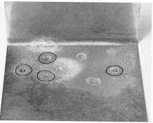
Bild 4. Lochfrass an einem Winkelblech aus austenitischem Chrom-Nickel-Stahl mit vier Löchern, verursacht durch stark chloridhaltiges Wasser
