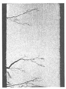
Bild 7. Transkristalline Spannungsrisskorrosion in einem Stab aus Chrom-Nickel-Stahl von 10 mm Durchmesser. Die Rissspitzen sind fein verästelt und reichen bis tief in den Stab hinein (vgl. Schweizer Ingenieur und Architekt 103 [1985] 4.23 S. 567)
