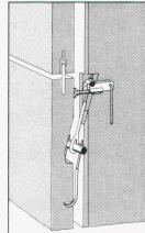
Ankersysteme für Beton und Kunststein, Naturstein, Mauerwerk aussen.
