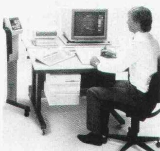
Das Bild zeigt einen auf dem neuen Arbeitsplatzrechner HP 9000, Serie 300, aufgebauten CAD-Arbeitsplatz. Dieser Rechner zeichnet sich durch seine Modularität aus: Man kann zwischen zwei Zentraleinheiten (16 oder 32 Bit) und verschiedenen Bildschirmen wählen. Das Be-
