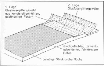
legt (Schema-Bild), welche die mechanischen Éigenschaften der Platte von der Plattenrichtung unabhängig machen und als Armierung die Platte entscheidend verstärken.
