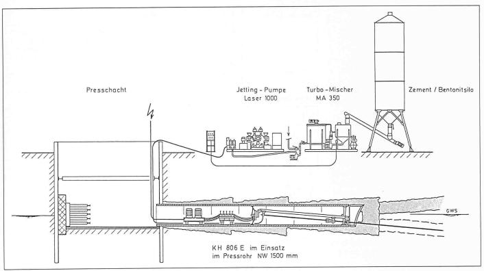
Verfahrensprinzip. Der anstehende Boden wird mittels glockenförmig angeordneter Jetting-Säulen verdichtet und konsolidiert
