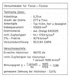
Tabelle 3. Resultate des Bruchversuches am stärksten Paralleldrahtkabel für die Farø-Brücke
