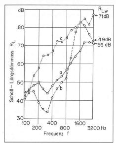
Bild 4. Schall-Längsdämmungen einer Aussenwand mit Innendämmung (Laborwerte) nach [5]; a Wand ohne Verkleidung, b Verkleidung aus Gipskarton- und Hartschaumplatten, mit Gipspflastern befestigt (verschlechterte Längs-Schalldämmung wegen Resonanz), c Verkleidung aus Gipskartonplatten, auf 30 mm Mineralfaserplatten vollflächig geklebt (verbesserte Längs-Schalldämmung)
