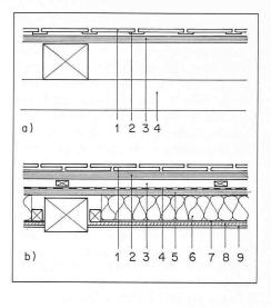
Bild 5. Wärmedämmende Dachsanierung nach [13]; a) vor der Sanierung, 1 alte Dachziegel, 2 Holzschindeln, 3 Schalung 30 mm, 4 Andreaskreuz; b) nach der Sanierung, 1 Biberschwanz-Doppeldekkung, 2 Dachlattung 24/38 mm, 3 Konterlattung 24/48 mm, 4 Glasvliesbitumen-Dachbahn, 5 rauhe Schalung 24 mm, 6 Wärmedämmung 100 mm, 7 Dampfsperre, 8 Holzspanplatten 16 mm, 9 Spachtelputz
