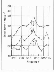
Bild 13. Verbesserung alter Holzfenster nach Moll [19]; 1 altes Holz-Verbundfenster ohne Dichtung,  $I_a \approx 19 \, dB$ ; 2 wie 1, jedoch mit zusätzlicher Falzdichtung,  $I_a \approx 29 \, dB$ ; 3 wie 2, jedoch mit Vorsatzfenster in 35 mm Abstand,  $I_a \approx 41 \, db$
