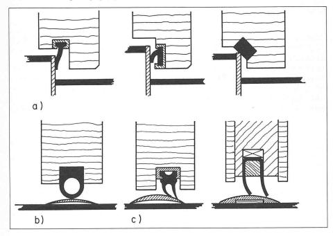
druck zu gross und deshalb ungünstig (Bild 15a). Im Gegensatz dazu sind Lippenprofile geeigneter wegen ihrer guten Einfederung bei kleinem Anpressdruck (Bild 15b).
