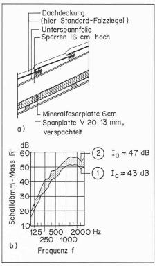
Verschiedene Ziegel- oder Dachpfanneneindeckungen mit gleicher unterseitiger Verkleidung nach [14]; a) sanierter Ziegeldachaufbau; b) möglicher Bereich der Schalldämmung
