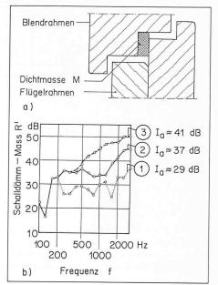
Bild 12. Altbaufenster; a) Verbesserung der Fugendichtung; b) vergleichbare Schalldämmungen, 1 undichtes Fenster, 2 Fenster mit Dichtmasse M aus Silikonkautschuk, 3 Fenster mit völlig gedichteten Fugen
