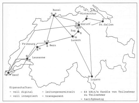
Bild 3. Das neue IFS-Swissnet, Ausbaustand Ende 1988
