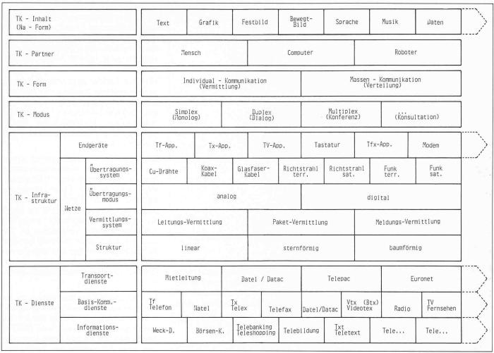
Bild 2. Elemente der Telekommunikation im Überblick
