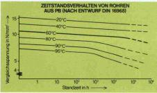
Die Graphik zeigt, wie stark und dauerhaft ein Polybutylen-Rohr ist. Trotz dieser enormen Festiakeit ist Polybutylen leicht zu verarbeiten, denn es ist auch das biegsamste Fussbodenheizungs Rohrmaterial aus Kunststoff. Der minimale Biegeradius beträgt nur 7,5 x Aussendurchmesser, und dies sogar bei 0°C.
