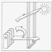
Dieses moderne Isolierglas besteht aus zwei oder drei Glasscheiben, wovon die eine mit einer Wärmeschutzschicht auf Edelmetallbasis versehen ist. Heglas neutral Silverstar wird dadurch zu einem echten Energiesparer, der dank modernster Technologie die Wärme besser im Raum hält, eine gute Sonnenkollektor-Wirkung bietet, mehr Licht durchlässt und deshalb viele anders beschichtete Isoliergläser in den Schatten stellt.
