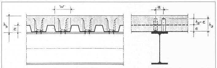
Ecublens. Es handelt sich um eine Erweiterung des Gebäudes «Centre Midi»: ein dreistöckiger Stahlbau mit 3500 m² Deckenfläche, wovon 2500 m² Montarib Verbunddecke mit einer totalen Stärke von 11 cm. Die Anzahl HVB-105, welche die Verbindung Stahlträger-Verbunddecke sowie das Zusammenwirken des Profilbleches Montarib mit dem Beton sicherstellen, beträgt 10 000 Stk., was einer Dichte von 4 Stk./m<sup>2</sup> entspricht.
