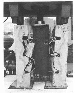
Versuchsaufbau. Die Längskraft wird mittels Hydraulikzylinder auf das Stahlprofil aufgebracht und über die Verbunddübel in die beiden Betonplatten eingeleitet, welche über eine Gummimatte auf dem Boden abgestützt sind, um die Last gleichmässig auf die beiden Platten zu verteilen
