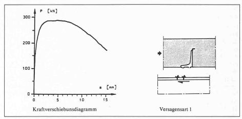
Bild 3. Duktiles Tragverhalten
