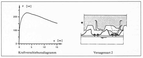
Bild 4. Duktiles Tragverhalten mit abfallendem Ast
