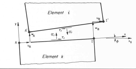
Bild 11. Verschiebungen und Spannungen am Risselement
