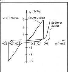
Bild 13. Modellierung der Rissoberfläche
