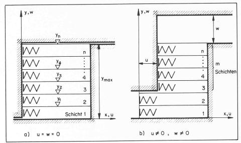
Bild 14. Geometrie der Schichtunterteilung der Rissoberfläche
