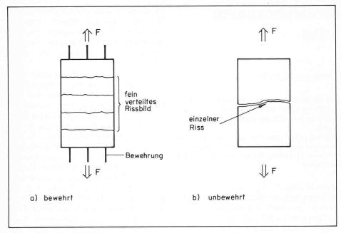
Bild 2. Unterschiedliches Rissverhalten von bewehrtem und unbewehrtem Beton
