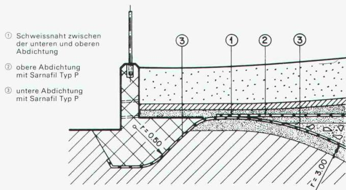
Endgültiger Seitenabschluss mit Kunststoffdichtungsbahnen Sarnafil Typ P nach dem Einfüllen der verseuchten Erde.
