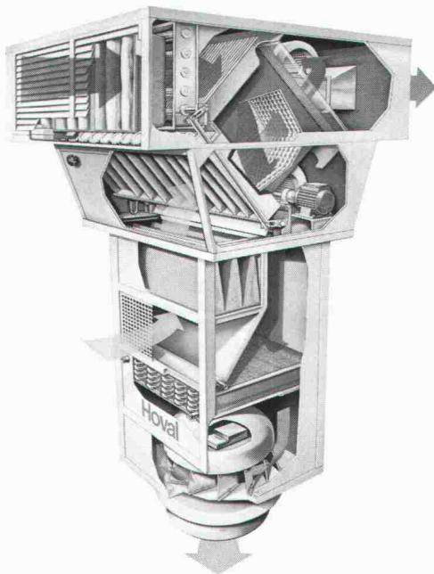
**Hoval HexaFlow.** Rotations-Wärme tauscher für regenerative Wärmerück gewinnung aus Abluft. Dieser äusser wirtschaftliche Wärmetauscher kann überall dort zum Einsatz, wo in luft technischen Anlagen sowohl ein Wär me- bzw. Kältetausch als auch eine Feuchtigkeitsübertragung gewünscht wird.
