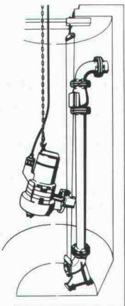
Die KRT wird von zwei Edelstahlseilen geführt, die das Hochziehen und Absenken in den Pumpensumpf zur problemlosen Aufgabe machen.
