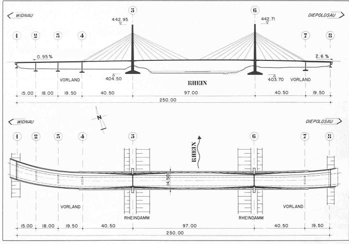
Bild 1. Längsschnitt und Grundriss
