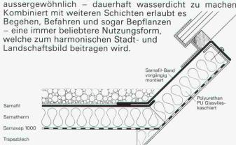
Anschluss der Sarnafil-Bedachung an Shedaufbauten.
