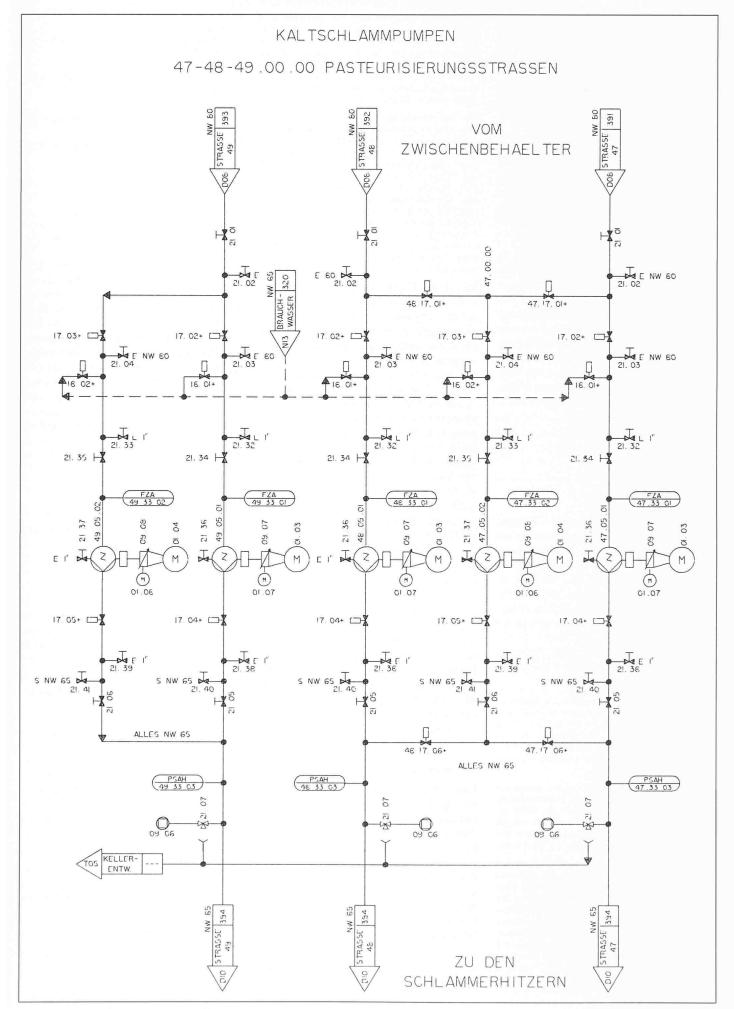
$Bild\ 4.\quad CAD\text{-}gezeichnetes\ Schema.\ Kaltschlammpumpen,\ Pasteurisierungsstrassen$
