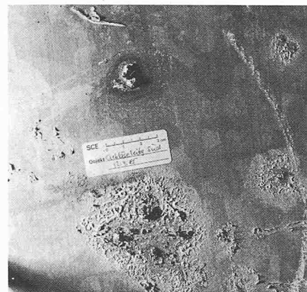
Bild 1. Verzinkungsfehler, die in der Verzinkerei nicht gesehen, von der Korrosionsschutzüberwachung auf der Baustelle jedoch entdeckt wurden
