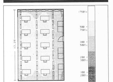
Bild 2 (rechts). Wichtige Kenngrössen der Beleuchtungsplanung werden graphisch dargestellt und als Entscheidungsgrundlage für den Kunden ausgedruckt. (Quelle: Zumtobel AG, Dornbirn)
