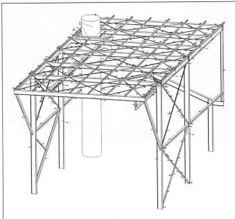
Bild I (oben). Perspektivische Ansichten von Tragstrukturen helfen mit, bestimmte Montagevorgänge fehlerfrei vorzubereiten. (Quelle: Meto-Bau AG, Würenlingen)
