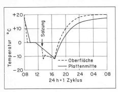
Bild 13. Temperaturverlauf der Pendelung bei Frostiausalz-Beständigkeitsprüfung für eine Platte von 75 mm Dicke
