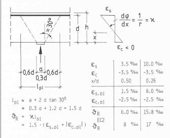
Bild 6. Vereinfachte Bestimmung eines unteren Grenzwertes der plastischen Rotationsfähigkeit 9 R
