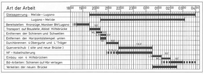
Bild 11. Einschiebeprogramm mit Zeitplan
