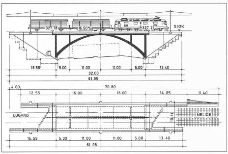
Bild 4. Längsschnitt und Grundriss
