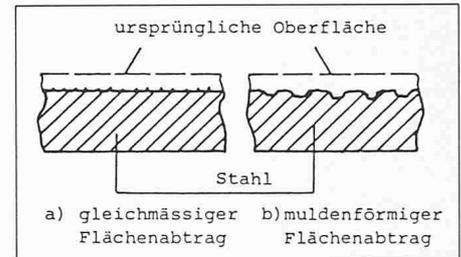
Bild 2. Flächenabtrag durch Korrosion
