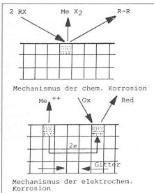
namisch) bzw. von der entsprechenden Werkstoff-Festigkeit abhängig, sondern werden auch von den Umgebungsbedingungen (Korrosionseinflüssen) stark mitbestimmt.
