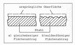
Bild 2. Flächenabtrag durch Korrosion
