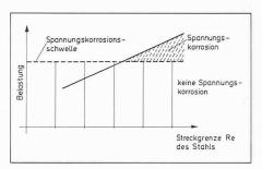
Bild 4. Spannungskorrosionsschwelle
