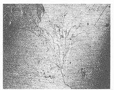
Bild 3. Spannungsrisskorrosion, Aussenfläche
