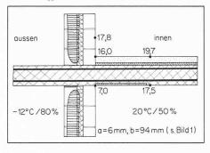
Bild 3. Wärmegedämmter Kragplattenanschluss mit durchgehendem Stahl III ohne Wärmedämmplatten an der Untersicht. Kondensationszone waagrecht schraffiert
