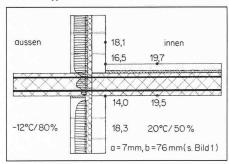
Bild 4. Kragplattenanschluss gemäss Bild 3, im Bereich einer Balkontür. Kondensationszone waagrecht schraffiert
