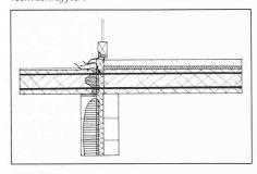
Bild 5. Wärmegedämmter Kragplattenanschluss mit nichtrostendem Stahl Typ V2A. Kondensationszone waagrecht schraffiert
