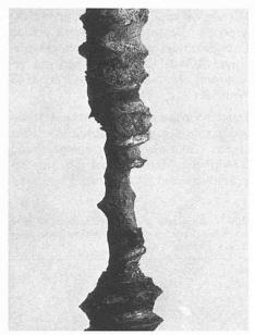
Bild 6. Befestigungsschraube mit Korrosionsschutzschicht nach acht Monaten in feuchtigkeitshaltiger Wärmedämmung
