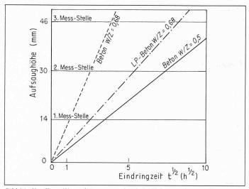
Bild 14. Kapillare Wasserleitung von drei bei  $50^{\circ}C$  getrockneten Betonsorten, ermittelt durch elektrische Leitfähigkeitsdetektion
