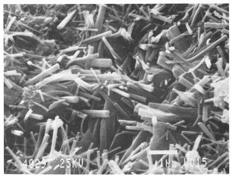
Bild 1. REM-Aufnahme von Hydratationsprodukten im Beton NB W/Z 0,68
