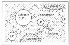
Bild 10. Schematische Erläuterung des Abstandsfak-
