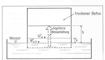
Bild 5 (links). Potentialgradient beim Aufsaugversuch
