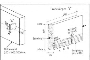
Bild 11 (links). Probekörper für Aufsaugversuche
