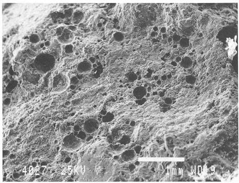
Bild 3. REM-Aufnahme von künstlichen Luftporen
