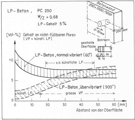
Bild 9. Gehalt an nichtfüllbaren Poren in Funktion des Oberflächenabstandes bei Luftporenbeton normal und ühervihrieri
