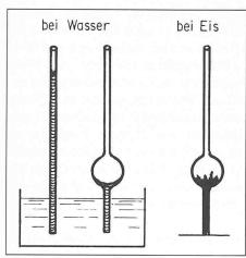
Bild 7. Modellvorstellung für die Funktion der Luftporen: Behinderung der kapillaren Wasserleitung und Wirkung als Expansionsgefäss beim Gefrieren
