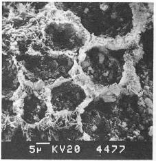
Bild 16. REM-Aufnahme. a verzweigte Kristalle an der Oberfläche einer Luftpore nach der Einwirkung von NaCℓ; b Übersichtsaufnahme
