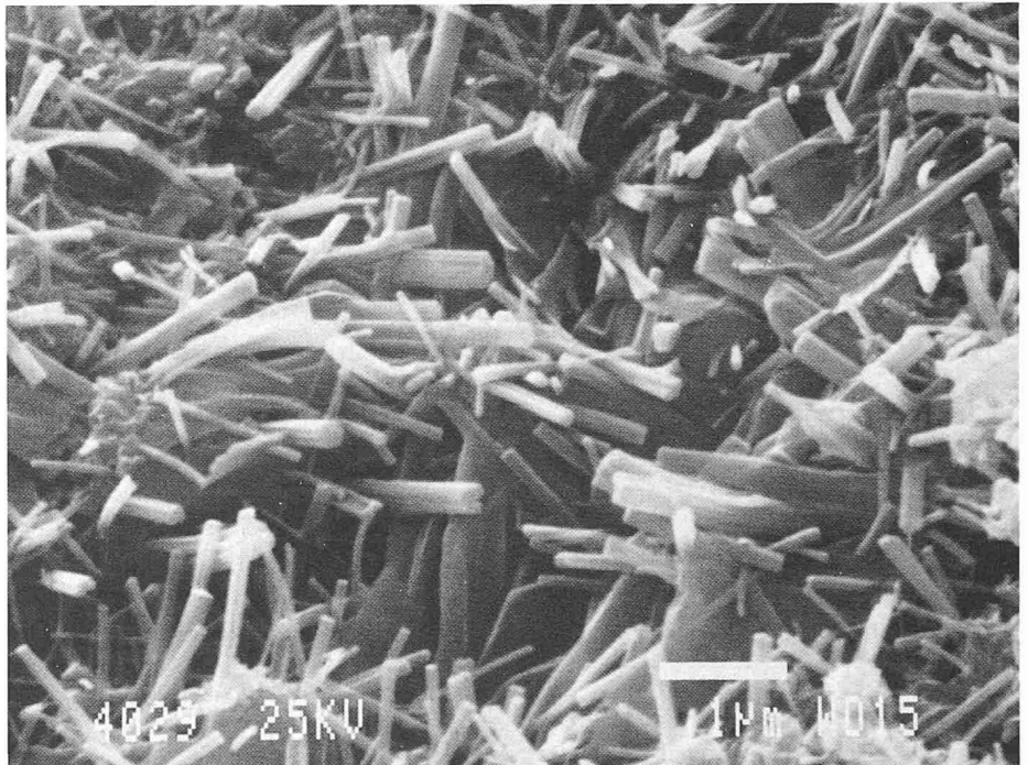
Bild 1. REM-Aufnahme von Hydratationsprodukten im Beton NB W/Z 0,68
