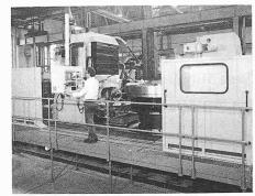
Pfauter P 2001/3000. CNC-Wälz- und -Formfräsmaschine für Zahnräder bei der SLM in Winterthur
